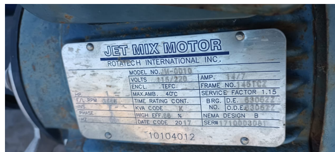
Ilustración 22. Placa de datos del motor de un aireador de inyección. Fuente: (Elaboración propia).
